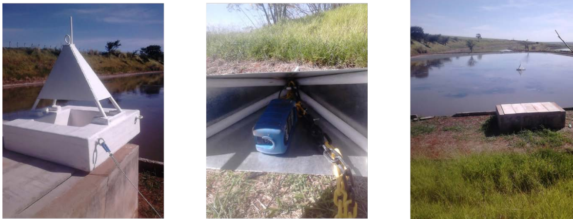
Figura 3 - Analisador de sulfeto de hidrogênio dentro do dispositivo de proteção
